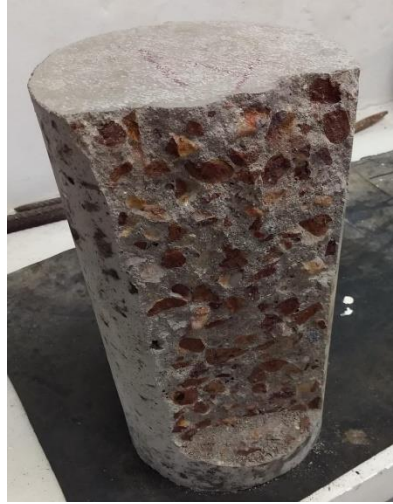
Figura 19: Ruptura dos agregados
