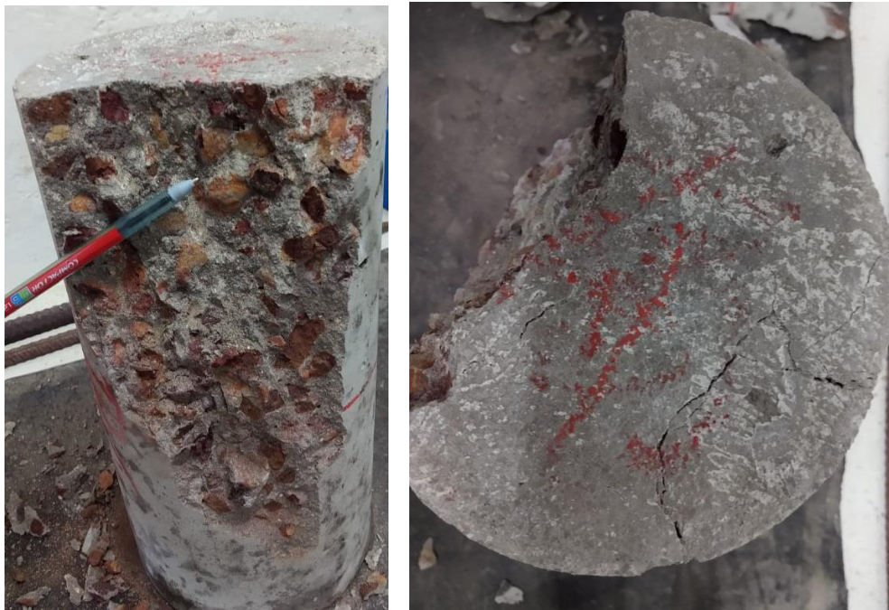
Figura 20: Ruptura colunar com formação de cones do CP4
